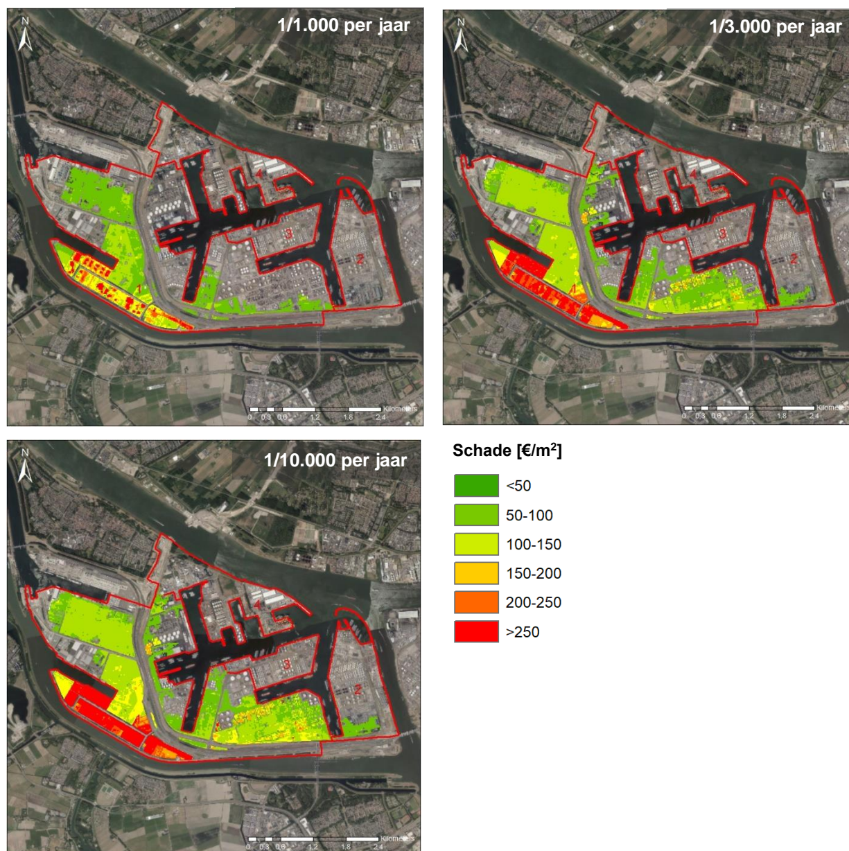
Figuur 4-1. Schadekaarten voor de huidige situatie met een overstromingskans van 1/1.000, 1/3.000 en 1/10.000 jaar
